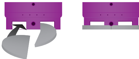
Bild 4: Einlegen der unteren Dämmung in den Fuß (links). Der Vliesstreifen umschließt den Fuß (rechts).
