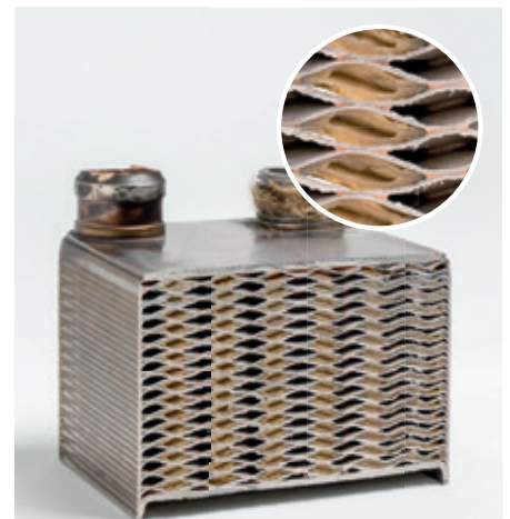
Plattenwärmetauscher (Frischwassermodul): Bedingt durch die engen Abstände im Plattentauscher kommt es häufig zu irreparablen Verkalkungen.
