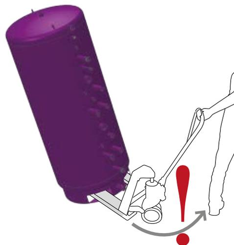
Bild 7: **Achtung** Kippgefahr bei unsachgemäßer Beförderung.
