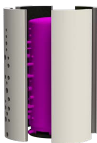
Bild 5: Aufstellen der Teilkreisschalen.
