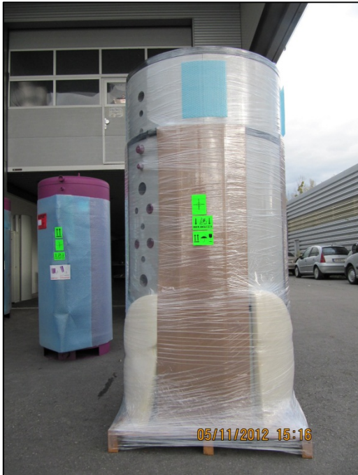
Speicher mit montierter Dämmung im Versandzustand Bruttoabmessungen LBH ca. 112 x 112 x 217 cm, ca. 230 kg
