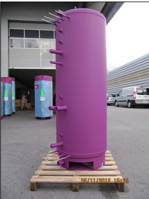
Frionic Speicher DM 850 mm Stutzen 45 ° versetzt auf EWP aufgesetzt, Ladungsträger überragen Stutzen um ca. 6 cm
