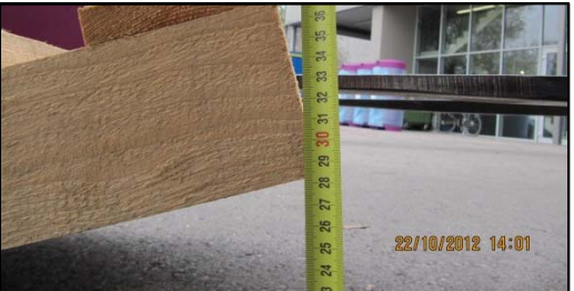
17 ° Neigungstest gem. EN 12195-1 ohne bleibend Verformungen bestanden, Belastbarkeit der Ladeinheit bis \mu_s 0,3 gegeben
