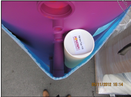
Beipack Thermometer, Anschlussstutzen durch selbstklebende, zweifach überlappende hochfeste Luftpolsterfolie geschützt
