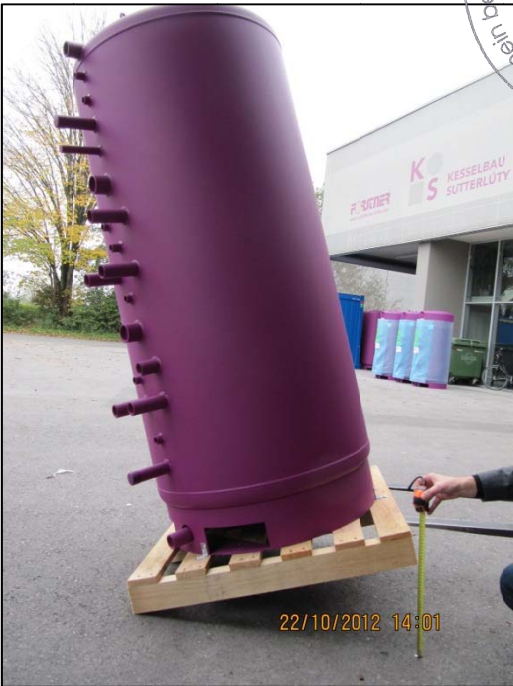
Schwerpunkt-, Kippmomentprüfung ergibt B_s 46 cm geteilt durch H_s 110 cm = 0,42, daher ohne LaSi nicht standfest
