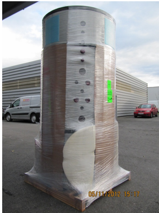
Anbringung Wellpappzuschnitt, zweiwellig B/C 7mm im Bereich Stutzen, Kopfbereich Luftpolsterfolie, Stretchung mit Wickelfolie
