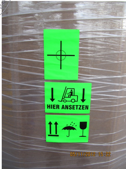
Selbsterklärende Symbole für Handlungshinweise gem. ISO R/ 780 und DIN 55402 an Front- und Rückseite
