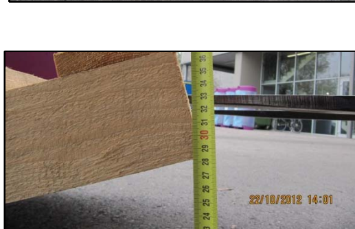
17 ° Neigungstest gem. EN 12195-1 ohne bleibend Verformungen bestanden, Belastbarkeit der Ladeinheit bis \mu_s 0,3 gegeben
