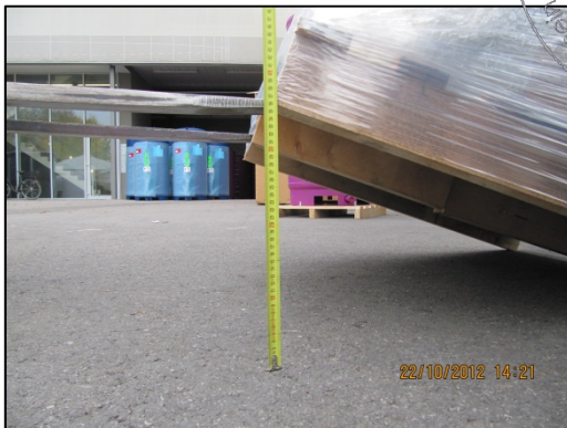
17 ° Neigungstest gem. EN 12195-1 ohne bleibend Verformungen bestanden, Belastbarkeit der Ladeinheit bis \mu_s 0,3 gegeben
