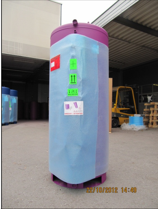
Selbstklebende, hoch belastbare, im Bereich der Stützen überlappende Luftpolsterfolie (80µ LDPE EM top Contact) schützt gegen äußere mechanische Belastungen
