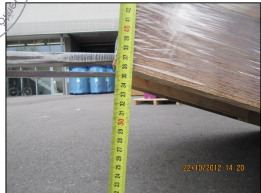
17 ° Neigungstest: Ladeinheit LB ca. 112 x 112 cm wurde einseitig um 36 cm angehoben, entspricht \mu_s 0,311 somit > 0,3 G
