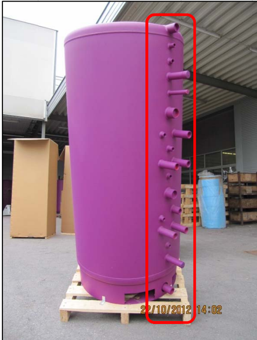
Speicher DM 850 mm wird mit Stützen 45 ° versetzt auf EWP aufgesetzt, Ladungsträger überragen Stützen um ca. 4 cm
