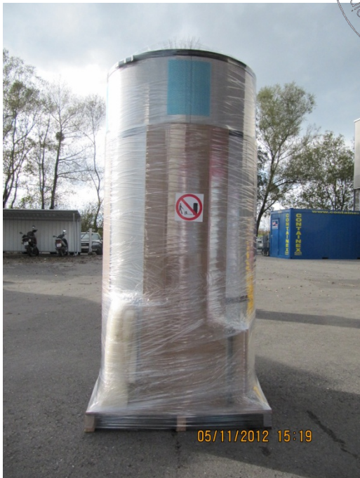
Anbringung Dämmung und Zubehör, Fixierung mit Spannbändern, oberer Abschluss montierte Deckelfolie, Rückseite
