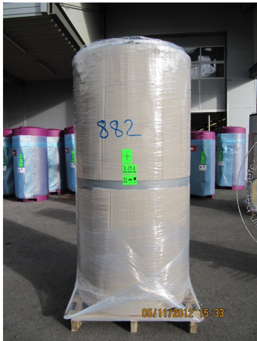
Edelstahl - Brauchwassererwärmer mit fix montierter Dämmung, oberer Abschluss durch montierte Deckelfolie, Vorderansicht
