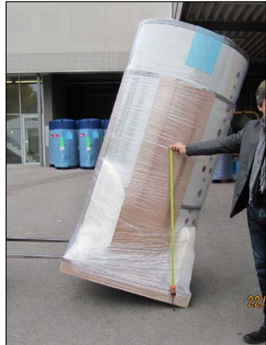
Schwerpunkt-, Kippmomentprüfung ergibt B_s 56 cm geteilt durch H_s 110 cm = 0,51, daher ohne LaSi nicht standfest
