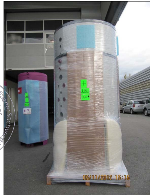
Anbringung Wellpappzuschnitt, zweiwellig B/C 7mm im Bereich Stutzen, Kopfbereich hochfeste Luftpolsterfolie und Stretchung
