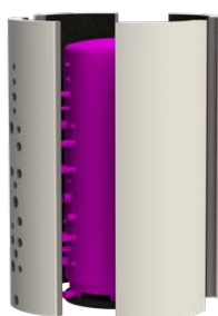
Bild 5: Aufstellen der Teilkreisschalen.
